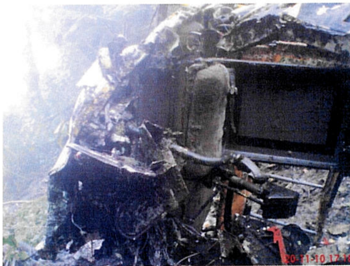
Foto 1.11. Silla y controles de vuelo del lado derecho (Piloto).
