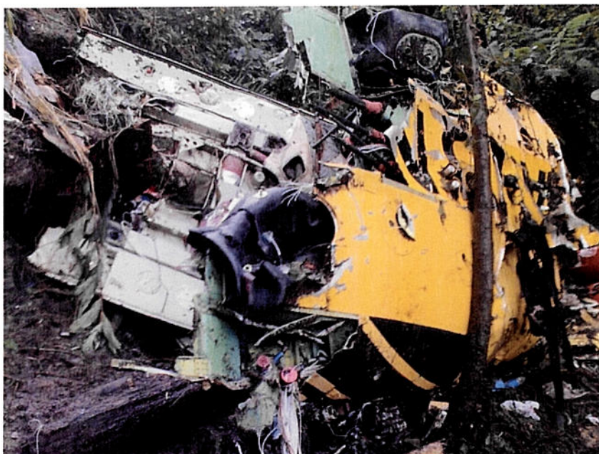
Foto 1.5. Parte inferior del fuselaje central (zona de carga) destruido, se observan algunas de las celdas de combustible rotas sin presencia de fuego.
