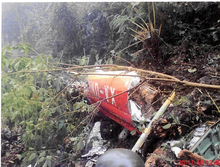
Foto 1.3. Estado final del helicóptero (se observa el botalón de cola con la matrícula de la aeronave)
