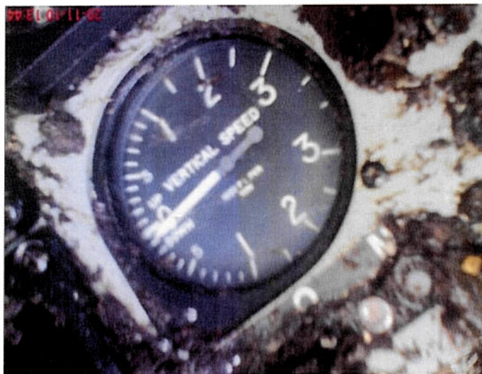
Fotos 1.17. Instrumento de velocidad vertical (variómetro) con un leve descenso no significativo.
