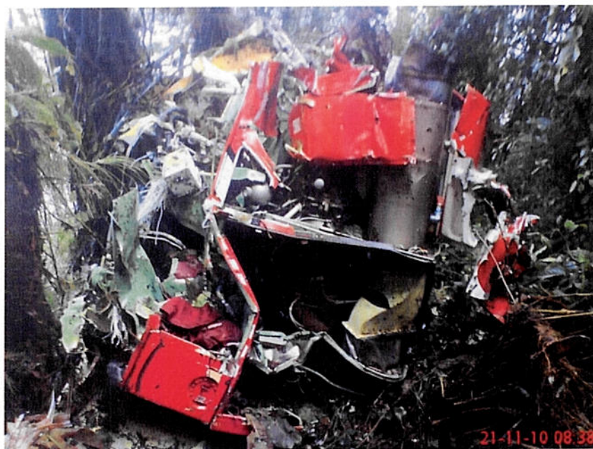
Foto 1.6. Parte del fuselaje sección motores
