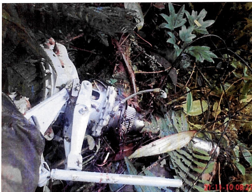
Foto 1.8. Parte de la transmisión y mástil del rotor principal desprendido de la estructura del helicóptero.
