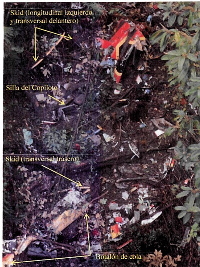
Foto 1.16. En la parte inferior de la foto se observa el botalón de cola con el estabilizador horizontal. En la parte superior de la foto se encuentra parte de la cubierta del motor y al costado izquierdo de la foto una sección del skid (transversal delantero y longitudinal derecho).
