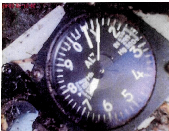
Foto 1.18. Instrumento de altímetro donde se observa un ajuste altimétrico de 29.92 pulgadas de mercurio y 7.120 pies de altitud.
