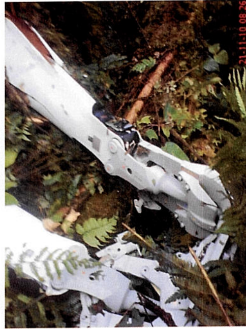
Foto 1.14 y 1.15. Foto izquierda, aspectos de una de las palas del rotor principal completamente destruida. Foto derecha, hub del rotor principal.
