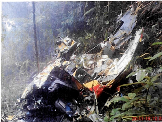
Foto 1.10. Helicóptero en posición invertida. Ausencia de la nariz del helicóptero, de las puertas de carga y puertas de cabina de pilotos y parte del piso de la aeronave
