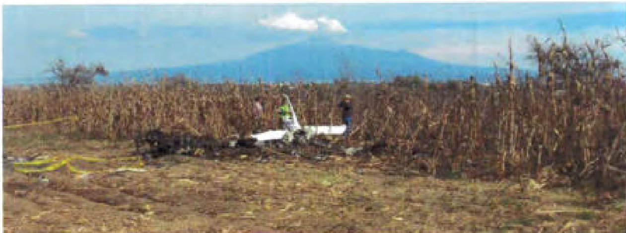
Fig. 1.1.3. Los restos principales se concentraron en un solo punto de impacto, no hubo desplazamiento en tierra
