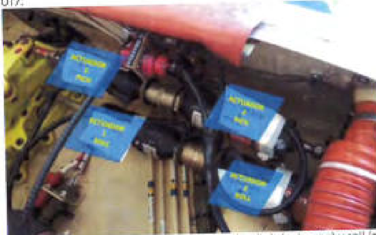
2.2.3.1. Ubicación de diseño de los actuadores de pitch (cabeceo) y roll (alabeo)
