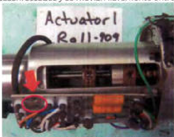
2.2.2.2.a Actuador lineal de roll SAS1 con los tornillos faltantes y el tornillo de bola se relaciona con alabeo a la izquierda.
