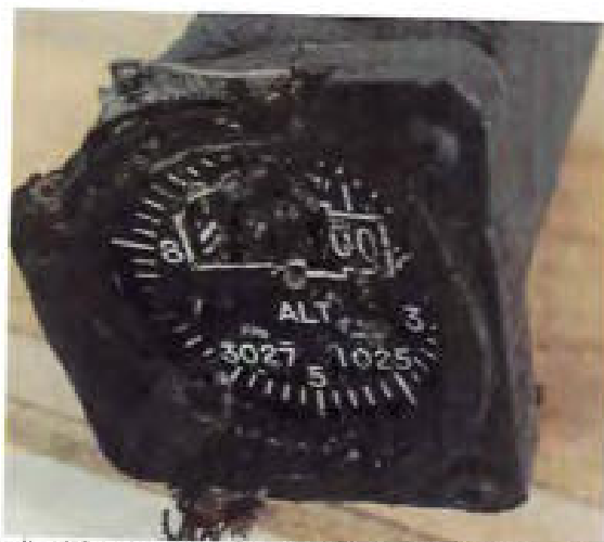
Fig. 1.15.2.2. Radioaltímetro con la indicación de 1,600 pies sobre el terreno
