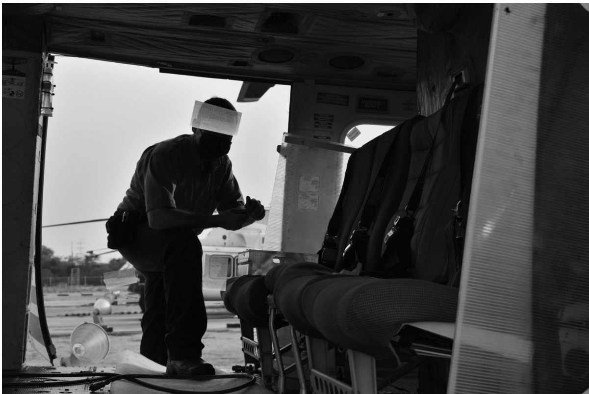
Imagen 8. Técnico instalando una mampara divisora.
